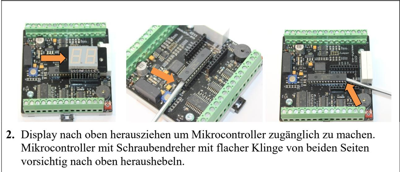
2. Display nach oben herausziehen um Mikrocontroller zugänglich zu machen. Mikrocontroller mit Schraubendreher mit flacher Klinge von beiden Seiten vorsichtig nach oben heraushebeln.
