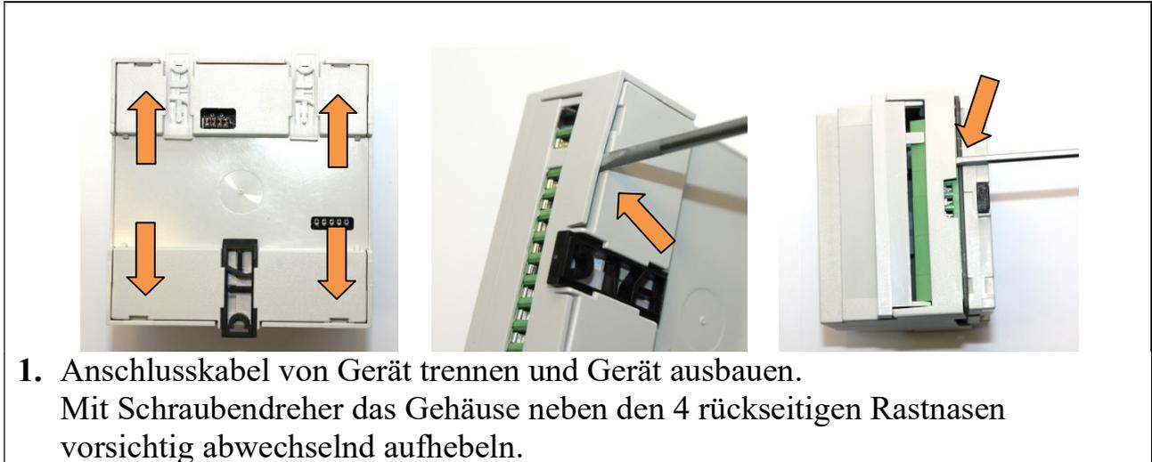
1. Anschlusskabel von Gerät trennen und Gerät ausbauen.
